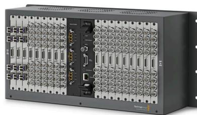
Конструкция корпуса позволяет использовать до 18 BNC- или оптических модульных интерфейсов для работы с SDI-сигналом, одну коммутационную матрицу 72 x 72 и плату питания. В комплект поставки входит съемный лоток и вентиляторы.
