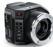
Самая миниатюрная цифровая кинокамера с матрицей Super 16, байонетом MFT и диапазоном в 13 ступеней для дистанционной съемки. Благодаря порту расширения с поддержкой сигналов PWM и S.Bus ею можно управлять в удаленном режиме с помощью любого радиопульта. Предусмотрены встроенный рекордер для записи в 1080HD с кадровой частотой до 60 fps. Сохранение ведется на SD-карту в CinemaDNG RAW или ProRes.
