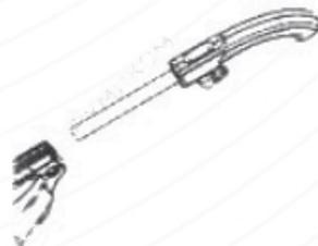
1. Откройте фиксатор металлической трубки, вытащите трубку.
