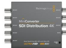
Mini Converter SDI Distribution 4K имеет восемь выходов для вывода одного регенерированного SDI-сигнала на несколько устройств. Есть возможность переключения между SD-SDI, HD-SDI, 3G-SDI и 6G-SDI, предусмотрена поддержка ASI, дополнительных данных и форматов со встроенным звуком.
