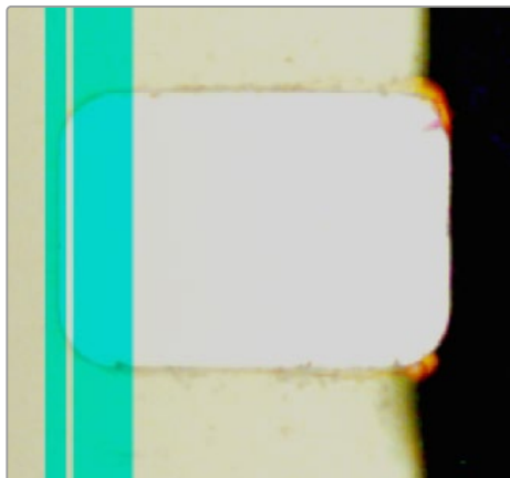
Ist eine HDR-16mm-Führungsplatte installiert, orientiert sich der Stabilisator automatisch an der anderen Seite der Perforation, um das Filmbild nicht zu beeinträchtigen und um die horizontale Stabilisierung zu verbessern. Eine 16mm-Führungsplatte, die nicht HDR-kompatibel ist, funktioniert genauso wie eine 35mm-Führungsplatte
