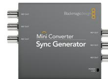
Модель имеет шесть видеовыходов с кварцевой стабилизацией частоты для синхронизации всех устройств в студии, которые поддерживают Tri-Sync (HD) или Blackburst (SD). Идеальное решение для небольших студий и вещания в мобильных условиях!
