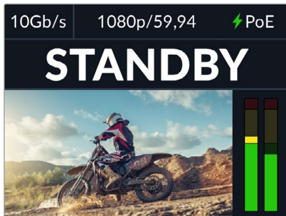
После подключения питания и соединения с источником видеосигнала индикатор PoE загорится зеленым, а на дисплее вскоре появится надпись STANDBY
