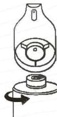
6. Установите бутылку с мылом в слот корпуса мыльницы, слегка поверните для надежного закрепления.
