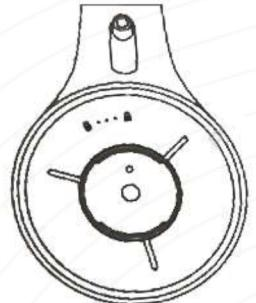
1. Поверните крышку, чтобы открыть аккумуляторный отсек.
