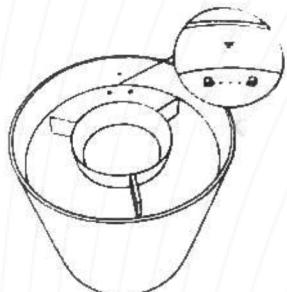
3. Совместите крышку и аккумуляторный отсек. На крышке предусмотрено два положения – «Разблокировано» и «Заблокировано».
