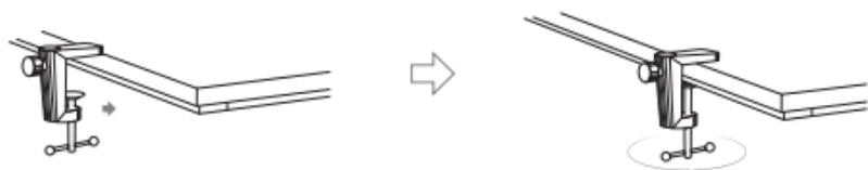
2. Подключите рычаг к основанию, отрегулируйте угол рычага с помощью фиксирующего зажима на основании
